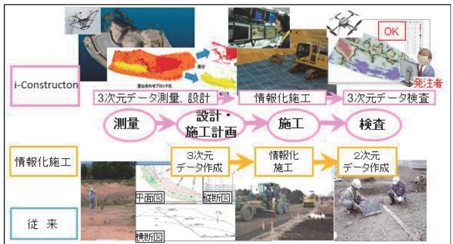
図-1 ICTの活用による土工全体の生産性向上
