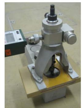
図-1 付着強度試験の状況
