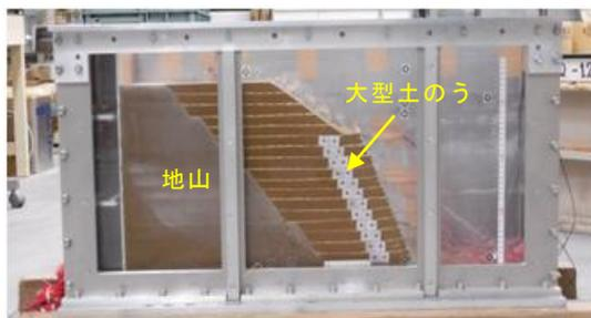
写真-4 模型地盤（補強土タイプ）
