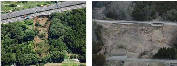
写真-1 道路盛土の被災現場（例）
