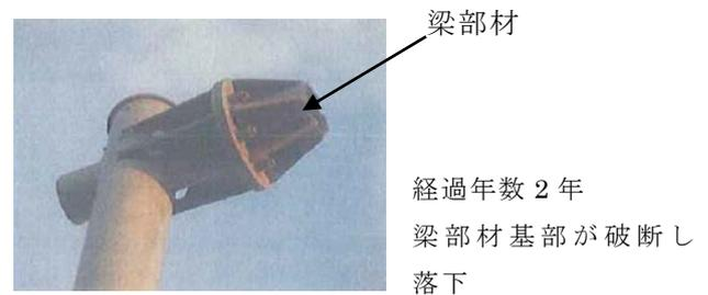
図-5 経過年数10年未満で発生した損傷の例
