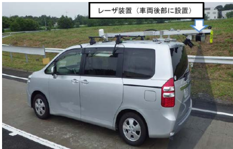
写真-3 測定車に搭載したわだち掘れレーザ装置
