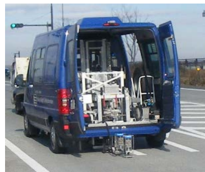
写真-1 FWD（重錘落下式たわみ測定装置）
