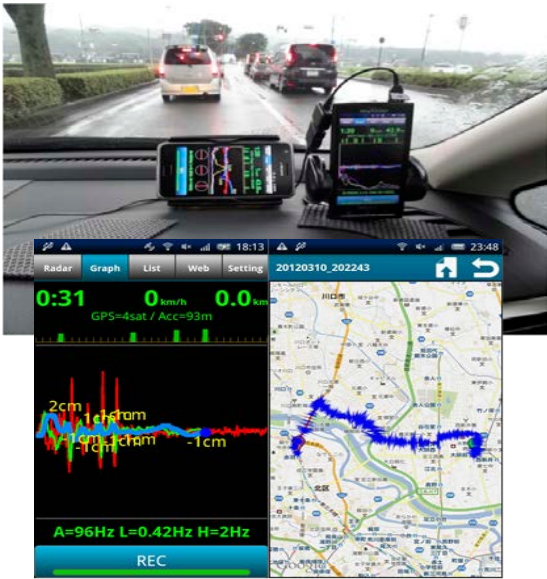
図-1 スマートフォンを用いたIRIの簡易計測例
