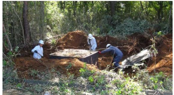
写真-4 樹木根を含む土壌供試体の採取状況
