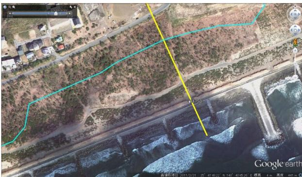
写真-3 千葉県旭市の海岸における砂丘の被災状況（黄線：測線，青線：浸水範囲）
