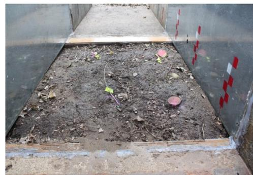
写真-6 侵食実験前の供試体の土壌表面
