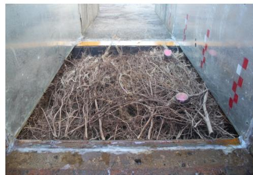
写真-7 高流速を作用させた後の供試体の表面
