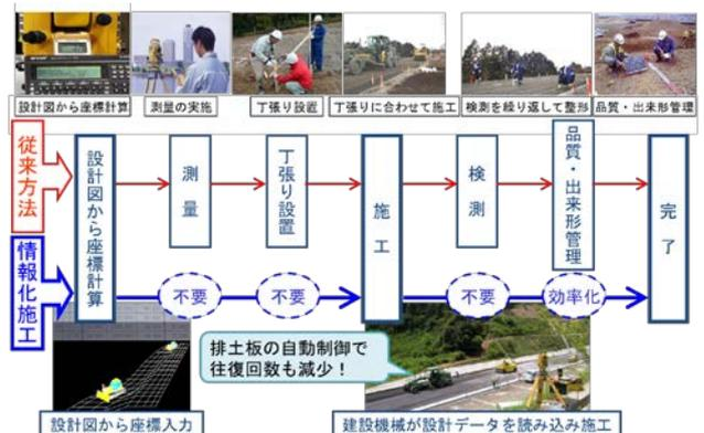
図-3 マシンコントロールの活用による施工の流れ
