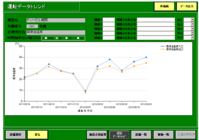
図-5 機械設備維持管理システム(画面例)
