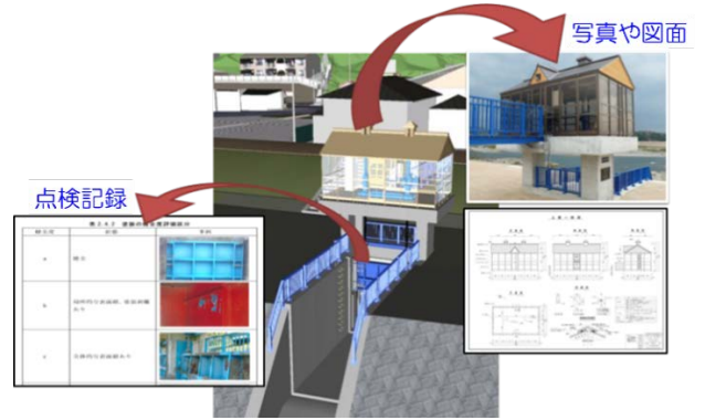
図-3 3次元モデルによる情報の一元管理
