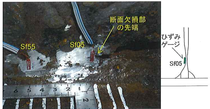
写真-6 ウェブ断面欠損部先端のひずみゲージ 注) 右断面図は外観目視による概念図
