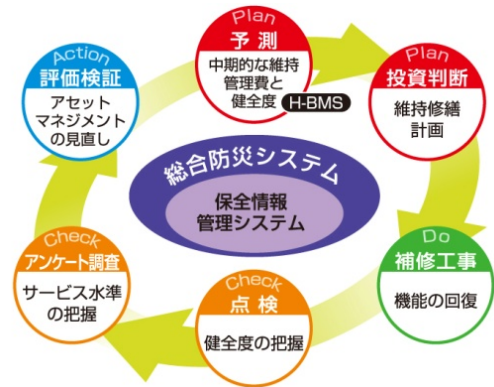
図-2 アセットマネジメントシステムの枠組み
