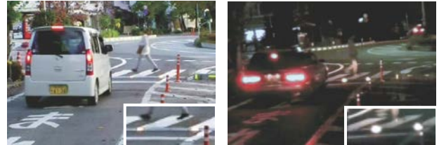
(a) 昼間 (b) 夜間 図-5 横断者検出時の発光鋸の点滅状況
