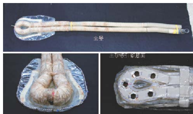
写真-3 潜行吸引式排砂管模型
