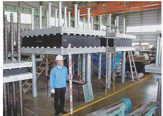
写真-5 わが国最大級の幅2m級のゴム支承
