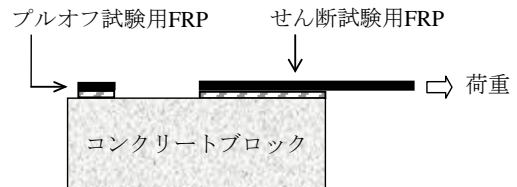
図-3 せん断付着試験方法の概要
