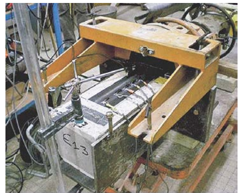
図-4 せん断付着試験の実施状況
