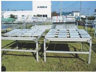
図-7 土木研究所における暴露試験の状況
