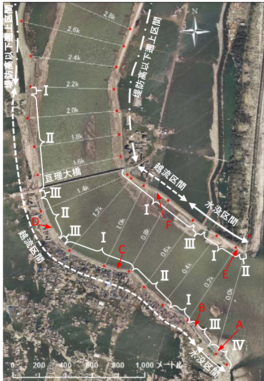
写真-1 津波痕跡水位と堤防高との関係及び被災状況
