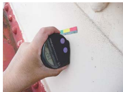
写真-2 膜厚計による測定状況
