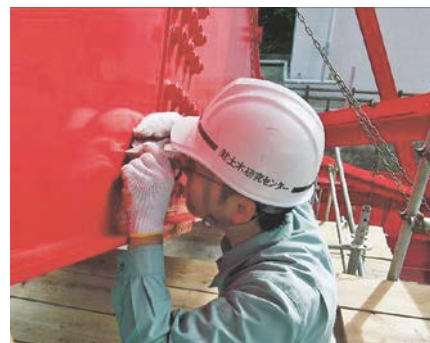
写真-2 膜厚計による測定状況
