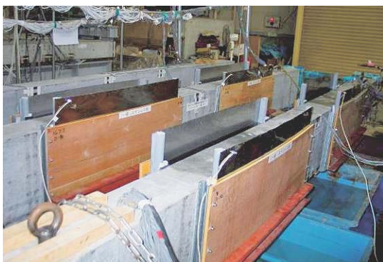
写真-2 電食の状況
