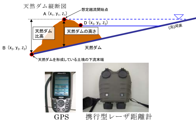
図-1 標準的なヘリ携行型レーザ距離計計測で用いるGPS、レーザ距離計と計測対象項目
