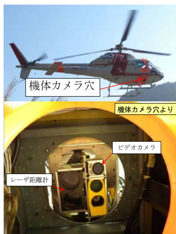
図-2 計測試験飛行の機器設置状況
