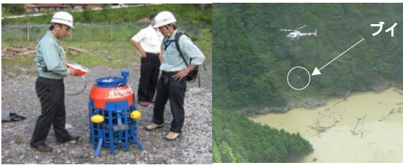
写真-1 土研式水位観測ブイ (投下型) (左：センサー概観、右：実際の設置状況)
