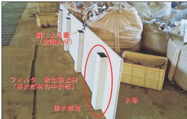
写真-2 実験に使用した排水機能付き矢板の模型
