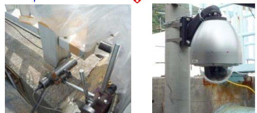
a) 変位計測 b) カメラ画像計測
