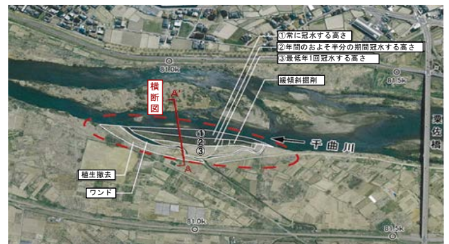
図-3 粟佐地区掘削形状(垂直写真)
