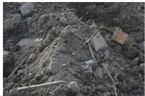
写真-2 掘り出された廃棄物
