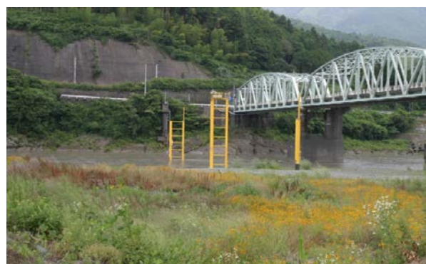
図-2 河床高自動計測のためのH鋼と南部橋
