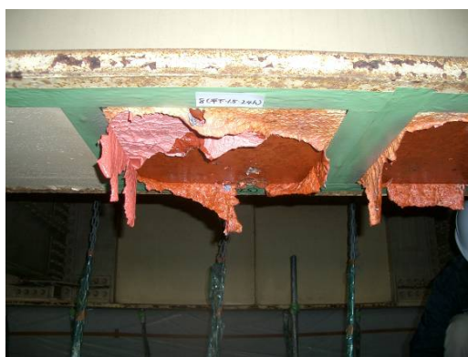
写真-6 塗装剥離剤「インバイロワン」による剥離試験
