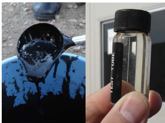
写真-5 (a)脱水前の底質 (b)脱水ろ過後の排水
