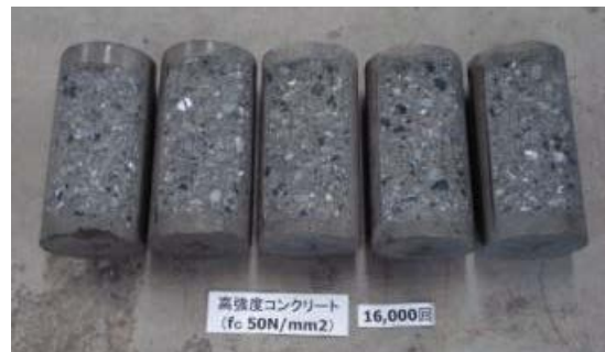
(b) 高強度コンクリート
