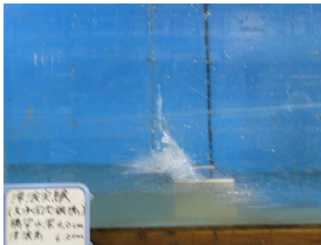
写真-1 津波衝突時の状況 (鋼橋：水深2m 津波高さ3m)
