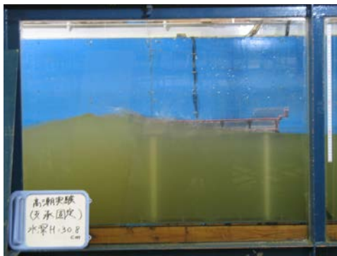
写真-3 高波衝突時の状況 (波高2.16m 周期5.3sec 水深7.7m)
