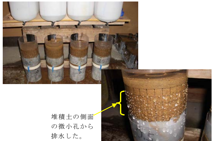
写真-8 堆積土中Cl - のコンクリート中への浸透試験
