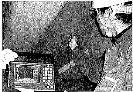
写真-1 実橋における探傷状況
