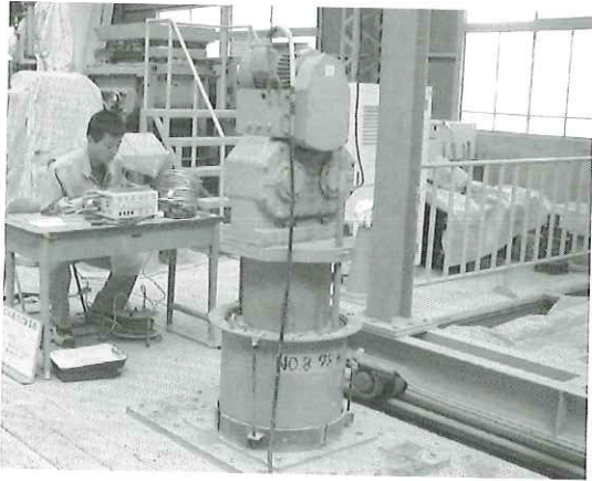
写真-5 大型供試体締め固め状況
