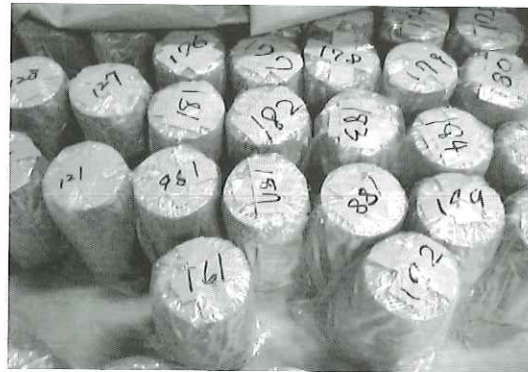
写真-3 封緘養生状況
