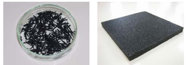
写真-1 歩道用凍結抑制弾性舗装版 (左: ひじき状ゴムチップ、右: 弾性舗装版)
