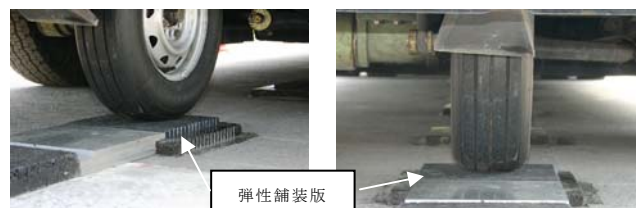
写真-2 試験タイヤ接地状況 (30×30×2cm)
