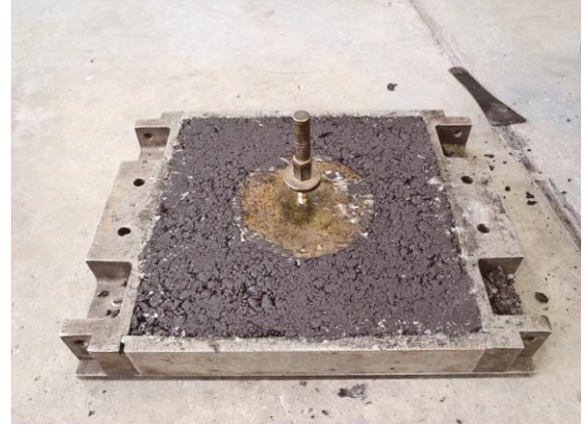
写真-4 金型による疑似ポットホールの作製
