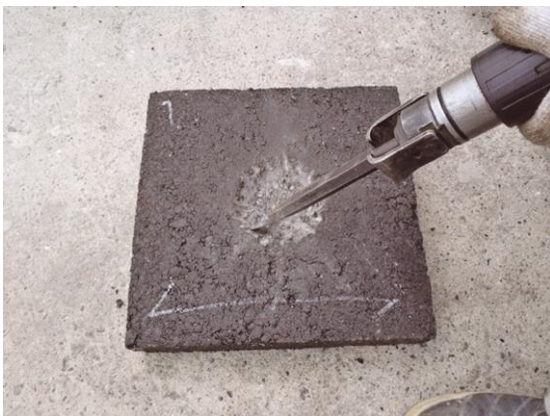
写真-3 電動ピックによる削孔
