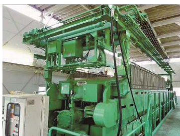
写真-1 高圧機械脱水 (PFP) 機
