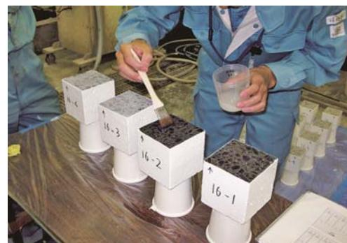
図-2 浸透材塗布状況
