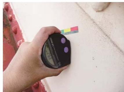
写真-2 膜厚計による測定状況
