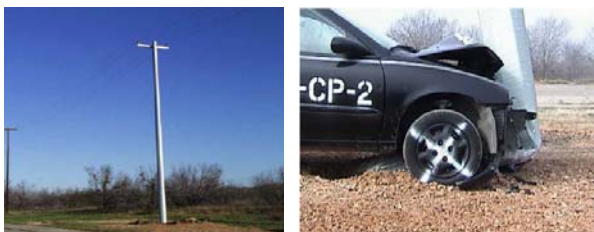
写真-2 電柱の衝撃緩和構造の例
