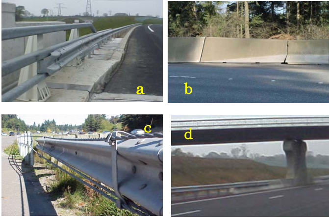
a. 橋梁防護柵とガードレール間 b. 形状の異なるコンクリート防護柵間 c. ガードレールとガードケーブル間 d. ガードレールとコンクリート防護柵間
