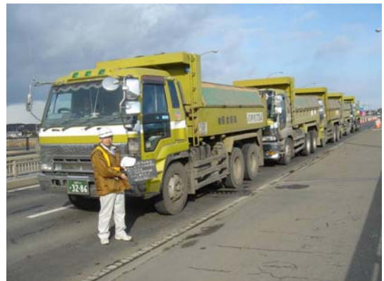
写真-5 載荷試験状況
