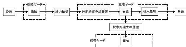
図-2 試験施工フロー
