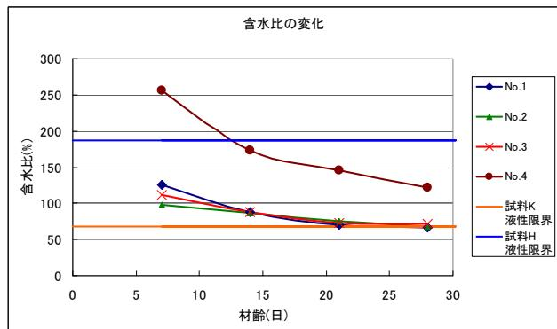
図・4 袋詰め底質の含水比の変化
