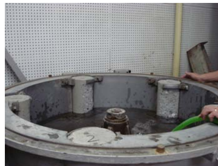
(b) 水道水注入状況
