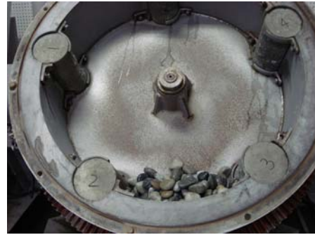
(a) 供試体セットと研磨材（骨材）投入
